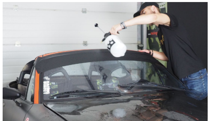
Bagnare la parte superiore della striscia parasole per proteggerla dalle eventuali rigature che potrebbero formarsi durante i successivi passaggi.
