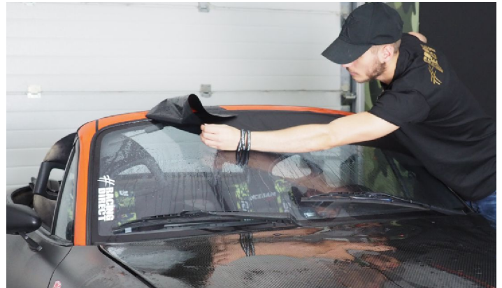
Sia la striscia che il parabrezza devono essere completamente bagnati. Posizionare l'adesivo in modo approssimativo, ma senza attaccarlo.
