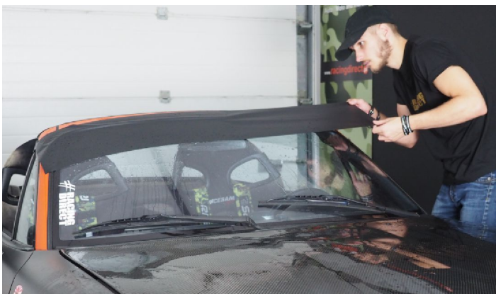
Tendere e posizionare correttamente l'adesivo. La superficie è bagnata, quindi si può rimuovere e riposizionare l'adesivo diverse volte.
