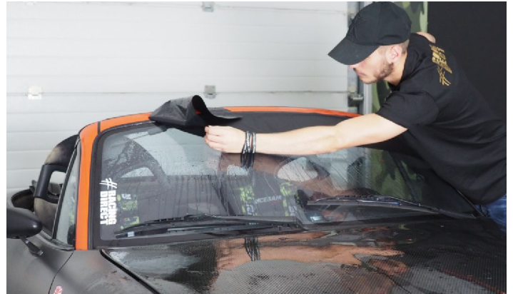
Poser le pare soleil approximativement sans chercher à le coller.
