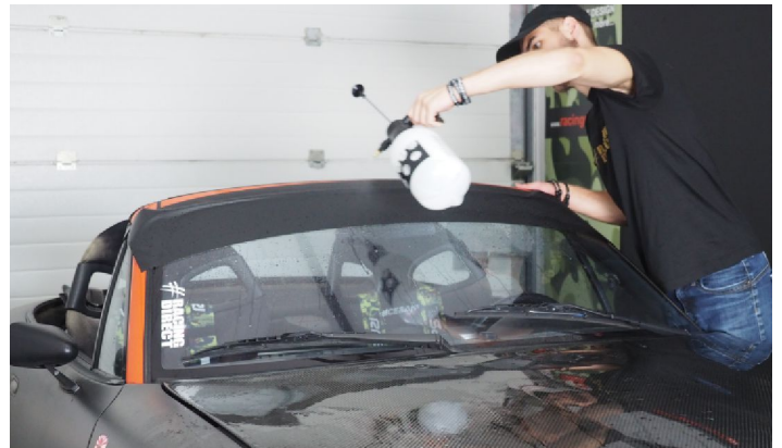
Mouiller le dessus du pare soleil pour le protéger des rayures pouvant être occasionnées dans les étapes suivantes.
