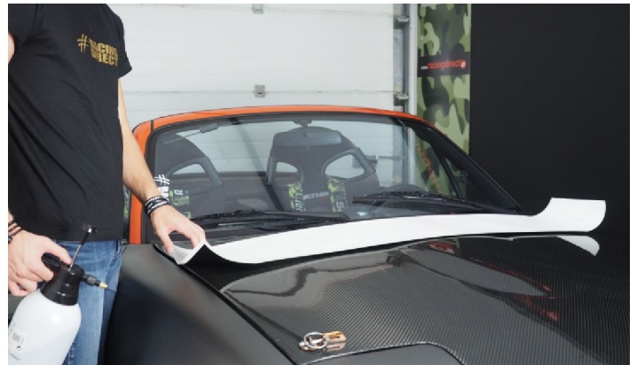
Placer la pare soleil à l'envers sur le capot, face contre la carrosserie.
