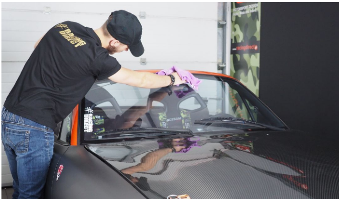
Nettoyer le pare-brise à l'eau claire SANS SAVON ! Sécher avec une micro-fibre.
